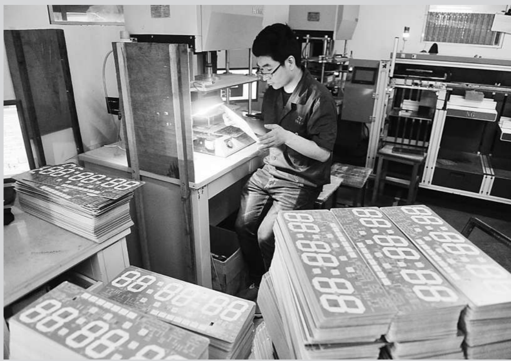
在杭州市临安区天目山镇佳有电子有限公司的生产车间内,工人在给电路板线路网、曝光、写影。公司主要生产销售印制电路板,因产品质量过硬,订单日渐增多,生产车间内一片繁忙。
