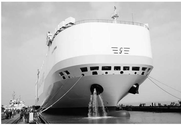
10月24日,扬帆集团股份有限公司承建的7800PCTC汽车滚装船首制船,在东海岸船业有限公司缓缓移出船坞,至上午9点,该船顺利完成二次进坞工作并出坞停靠靠装码头。船舶状态良好,并于当天下午进行倾斜试验,准备冲刺最后的交船节点。
