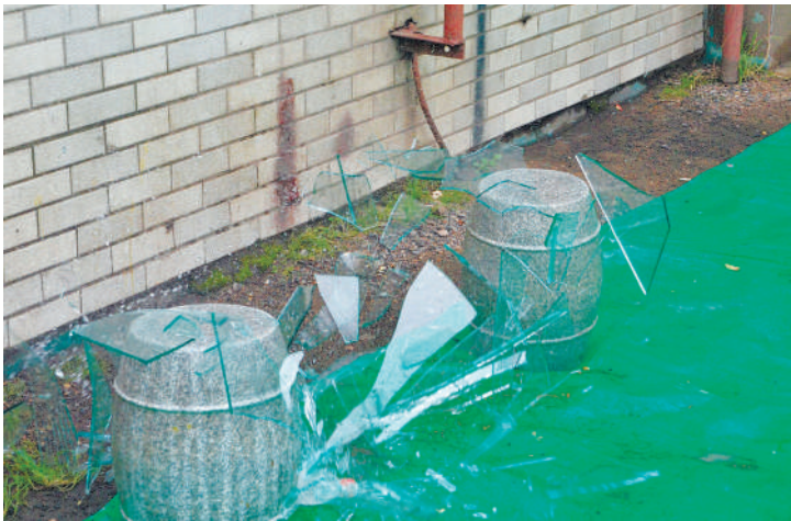
18米高度抛下一瓶矿泉水,未开盖的矿泉水砸裂5mm厚的普通玻璃。
