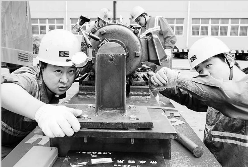
日前,宁波舟山港北仑矿石码头分公司举行“弘扬工匠精神,争做检修能手”的班组技能大比拼活动。钳工们采取两两搭配的方式展开角逐,通过比拼调整电动机底座与模拟减速机同轴度,提高班组的设备对中技术水平。图为参赛选手在认真查看百分
