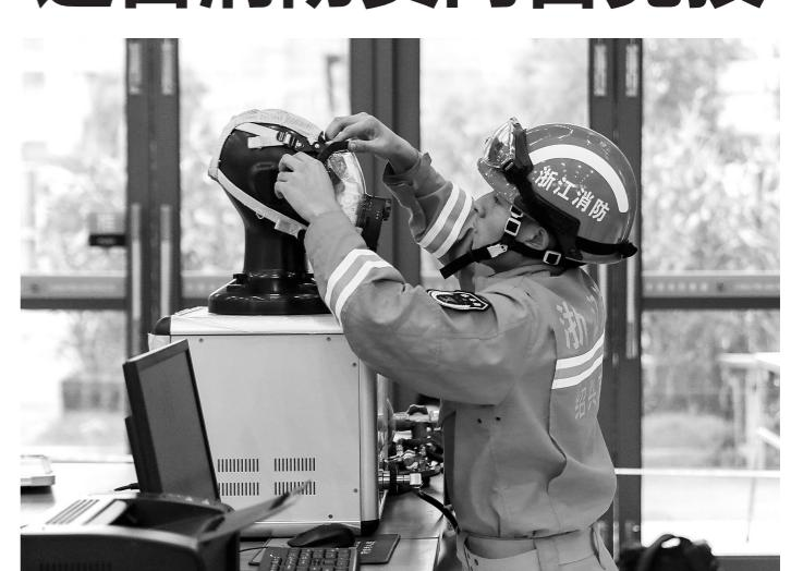
日前,绍兴市消防行业职业技能竞赛如火如荼举行了3天,99名消防员同台竞技,参加装备维护、应急救援、消防通信、灭火战斗、搜救犬训导、消防设施操作等6个组别、21个项目的角逐。图为消防队员正在进行正压式消防空气呼吸器故障诊断及排除项目的比拼。
