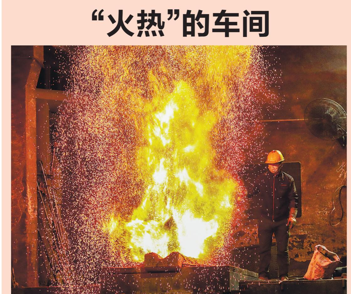
1月11日晚上，在杭州市临安区天目山镇天目铸造厂的车间内，一名工人正在检查炉膛钢水情况，准备浇铸模具配件。临近年关，天目山镇工业园区各企业开足马力加班加点赶订单，生产
