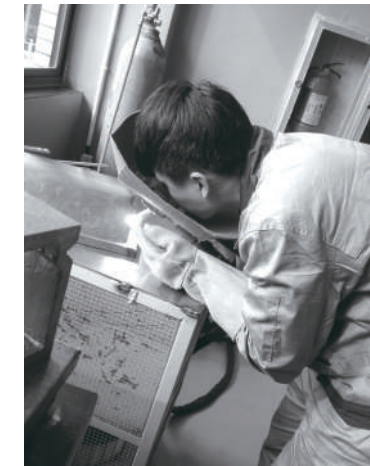
在钣金件制作模块,选手正在操作氩电弧焊。 雷虹 摄
