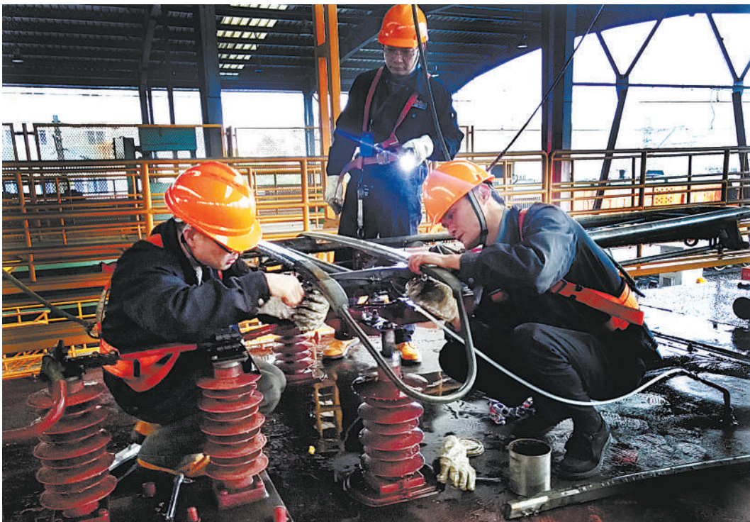
这几天铁路春运进入最繁忙时刻,为确保春运安全,铁路杭州机务段组织精兵强将精心检修火车头,重点对机车轮对、走行部和电力机车受电弓等关键部位进行检修检测,杜绝机车带病上线运行。
