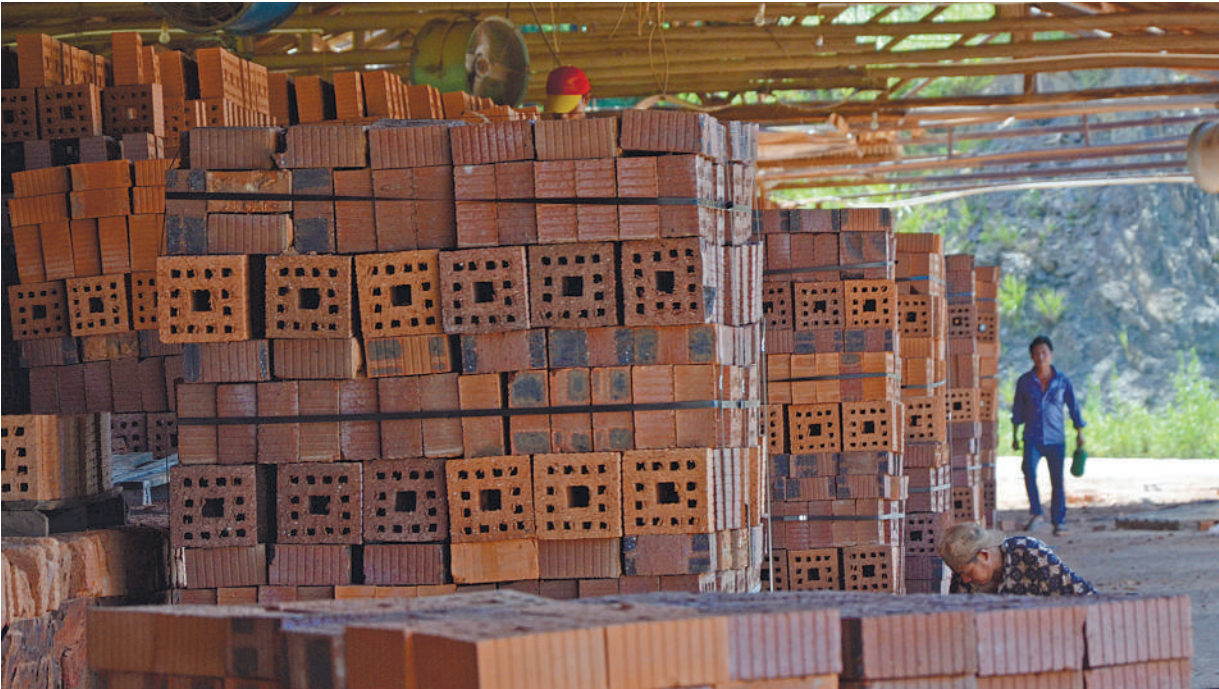
保护生态已是大趋势,2007年,楼峰砖瓦厂结束了就地取土的粘土实心砖的生产,改为生产烧结页岩多孔砖。
