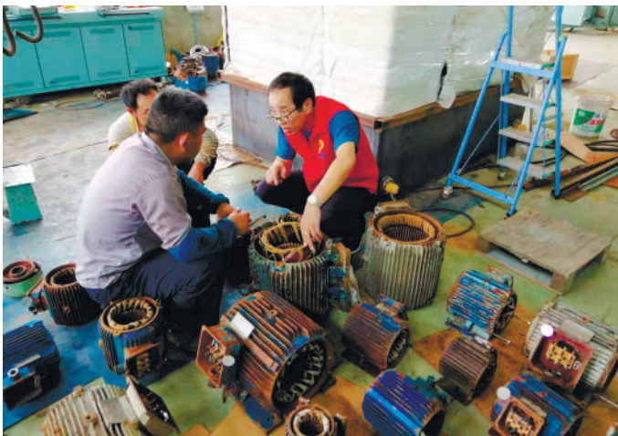
舟山市劳模工匠技术服务队在顺帆电器厂维修进水的轮船机电发动机设备。
