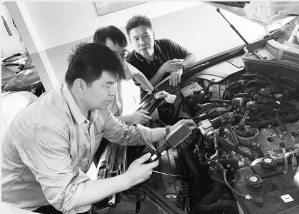
工作人员用数码内窥镜检测发动机。通讯员曹伟达 摄
