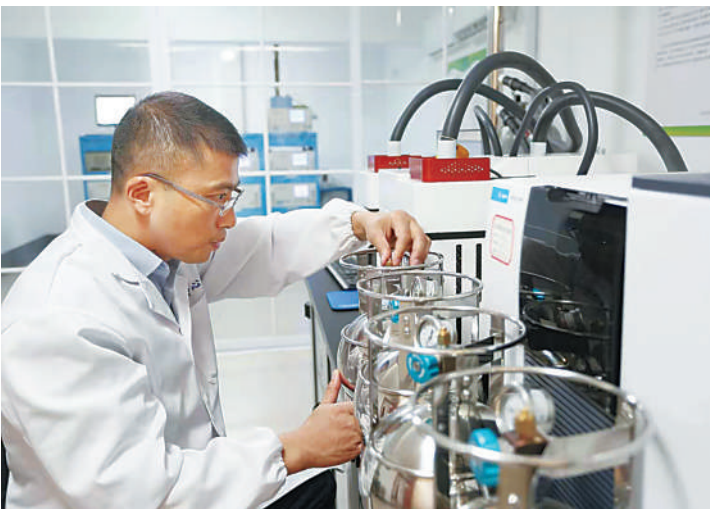
胡旌正在用GC-MS(气相色谱-质谱联用仪),检测空气中108种挥发性有机物含量。
