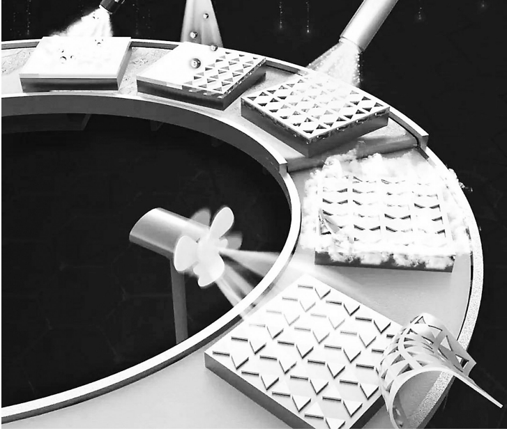
从冰层沉积开始到吹除废料结束，加工全程不涉及化学溶剂。
