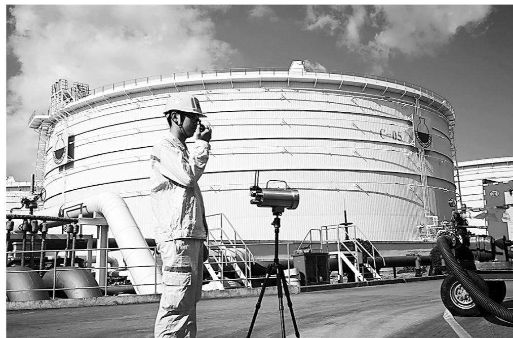
近日，全国最大单体石油岛——中化兴中石油转运(舟山)有限公司岙山基地，开始使用员工利用生产副班期间自主创新设计的实用新型专利产品——移动式防爆视频监控设备，对岙山库区进行可燃气体浓度监控检测。
