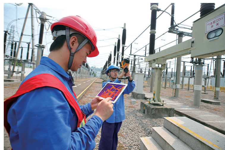
检修人员通过红外测温现场自动分析系统研判设备隐患情况。
