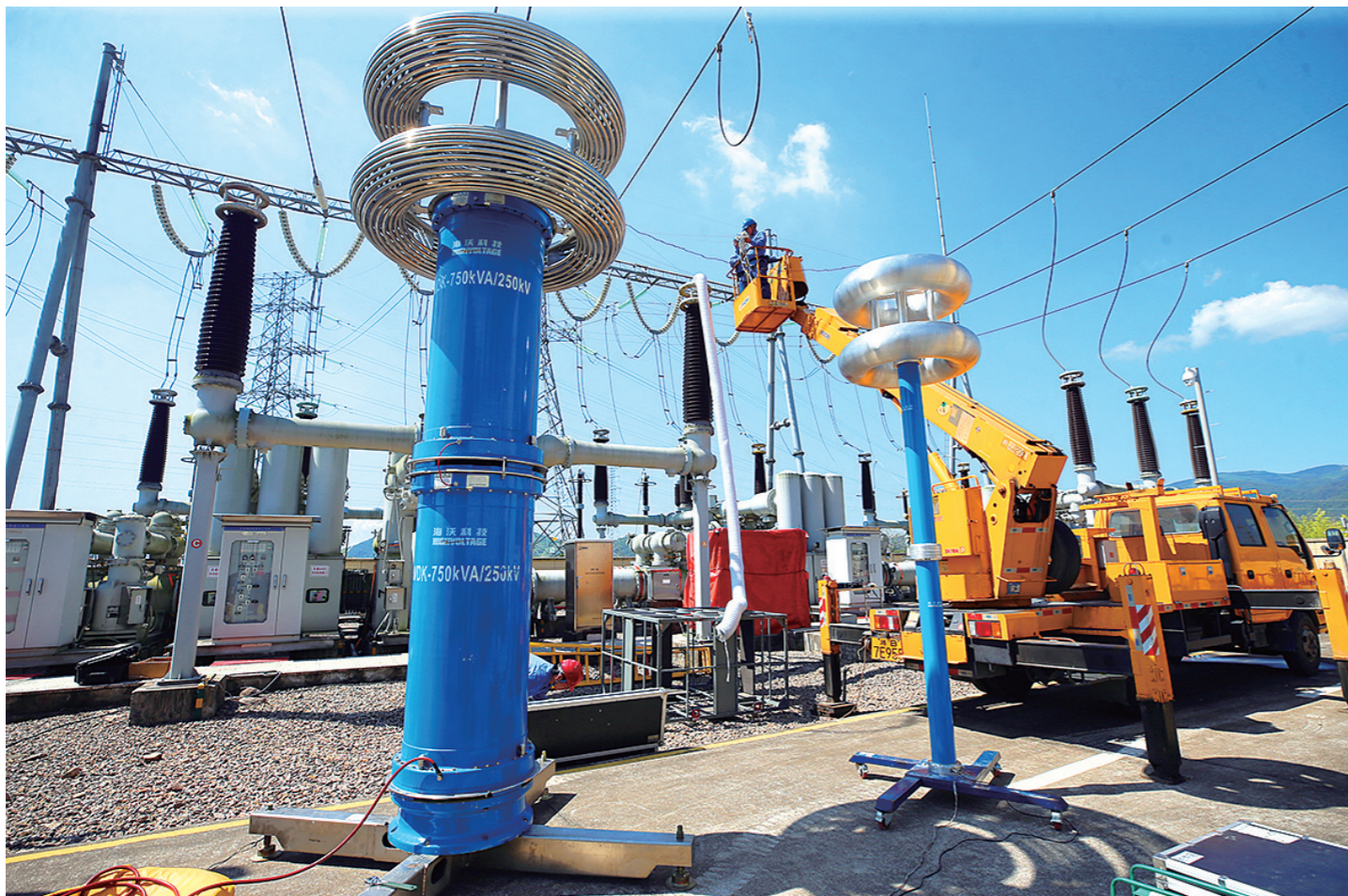
检修人员正在对220千伏通济变电站进行主变绝缘耐压试验。
