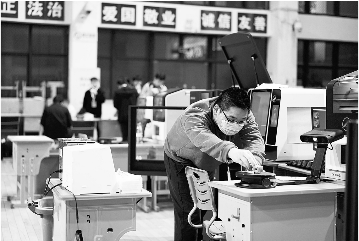
参赛选手正在用逆向工程技术对比赛提供的标准件进行3D扫描、数据采集,以创建3D数字模型。
