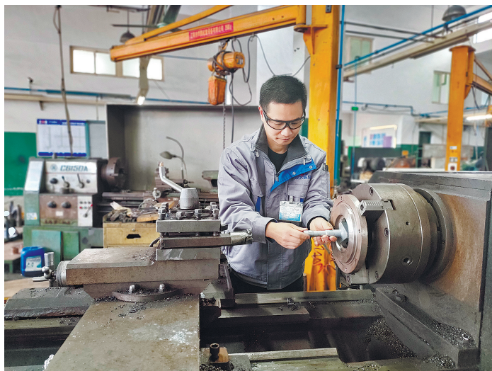
杨勇用内径千分尺测量工件尺寸。
