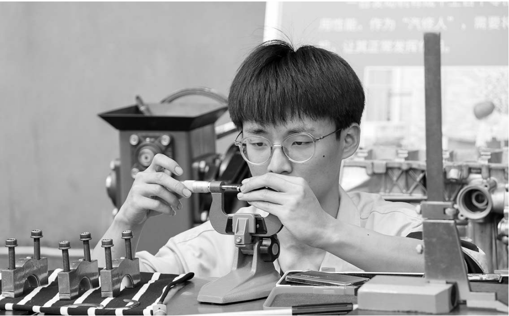
技能运动会现场,运动员正在认真校正千分尺的精度。
