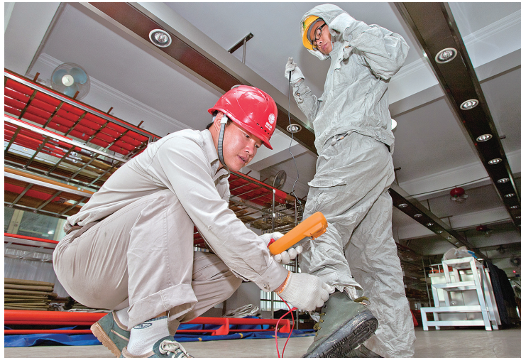
蒋卫东正在工具库房对带电作业屏蔽服进行电阻测量。(摄影 王平)
