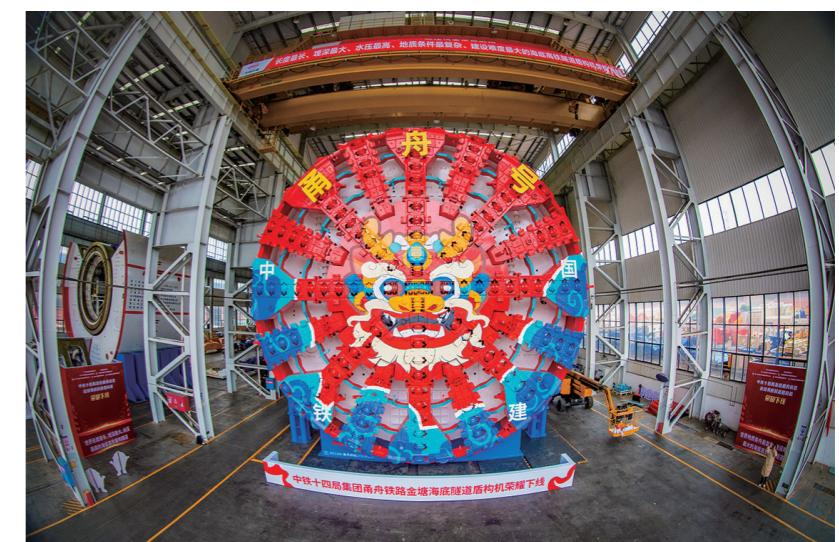
昨日,一台刀盘涂装“瑞龙”图案的超大直径盾构机“甬舟号”在湖南长沙下线,刀盘开挖直径14.57米,将应用于世界上最长海底高铁隧道——宁波至舟山铁路金塘海底隧道。
