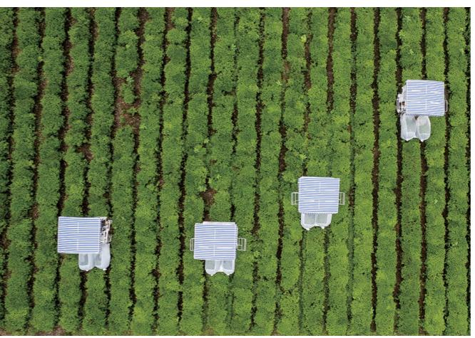
近日,金华婺城区一处茶园里,由浙江省农业机械研究院研制成功的新型国产乘坐式采茶修剪一体机在进行采茶机械化作业。新型国产乘坐式采茶修剪一体机不仅具备采摘功能,还可完成修剪作业,实现采修一体化,提高了茶叶采收效率。
